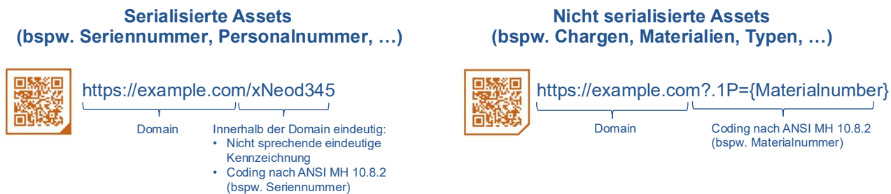
Abbildung 4: ID-Links für serialisierte und nicht serialisierte Assets. Bildquelle: Eigene Darstellung.
