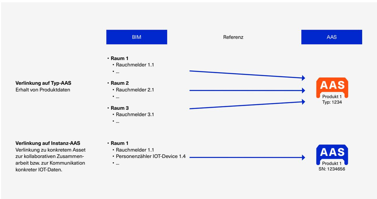
Abbildung 4: Referenzieren vom BIM-Modell auf die Elemente in der AAS (syn2tec)
