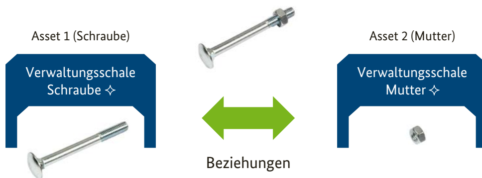
Bild 19: Eine Schraubverbindung wird in der Informationswelt durch Beziehungen zwischen der I4.0-Komponente „Schraube“ und der I4.0-Komponente „Mutter“ beschrieben
